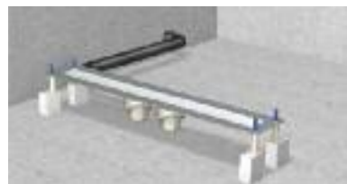
4 Posa delle tubazioni di scarico con allacciamento ai sifoni della canaletta.
