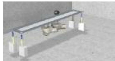
1 Montaggio dei sifoni e dei piedini con i relativi accessori alla canaletta.
