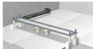
5 Posa dell'isolante termico sul pavimento.
