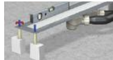
3 Mettere in bolla e all'altezza desiderata la canaletta mediante la regolazione dei piedini.
